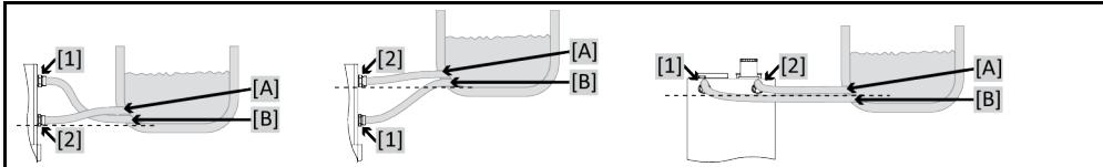
Для того чтобы эффективно контролировать систему и не допустить образования воздушных подушек внутри системы, убедитесь, что соединение термостата >Циркуляция выход< [1] подключено к нижнему соединению [B] внешней системы, а соединение >Циркуляция вход< [2] подключено к верхнему соединению [A] внешней системы. Обратите внимание на то, чтобы соединение внешней системы [B] были на том же уровне или немнога выше соединения >Циркуляция вход< [2].
