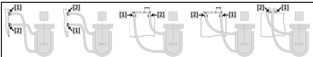
为使您的应用仪器能够正常工作且系统中没有气泡，温度控制器的 >循环出口< [1] 接口必须与应用仪器上位置较低的接口连接而温度控制器的 >循环入口< [2] 接口必须与应用仪器上高度位置相同或更高的接口连接。
